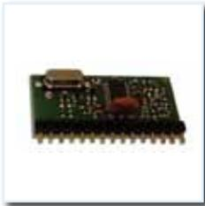
Empfängermodul UHF für tormatic Garagentorantriebe, Funkempfänger UHF und Ampelsteuerung
