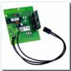
Empfänger E-43-L steckbar, für KeeLoq und Multibit, mit einem Transistorausgang für z.B. Schiebetransporte STA 270 / 280. Speichert bis zu 60 unterschiedliche Codes
