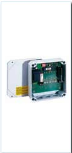
Empfänger E-41-1, im Gehäuse, externe Montage, mit einem Relaisausgang, Anschlussspannung 230 V, Umschaltbare Funktionen: Impuls, Ein / Aus oder Zeitimpuls.
